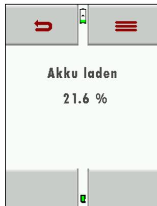
Das Batterie-Symbol im Display zeigt die verbleibende Kapazität des Akkus an. Ca. 60 Minuten (abhängig der Gerätekonfiguration) bevor der Akku leer ist, beginnt die Ladeanzeige im Sekundentakt rot zu blinken. Wenn der Akku nahezu leer ist, und das Messgerät nicht innerhalb einer Minute an die Netzversorgung angeschlossen wird, schaltet sich das Messgerät zur Vermeidung einer Akkutiefentladung ab.
