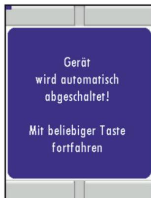
Rechtzeitig vor dem automatischen Ausschalten ertönt ein akustisches Signal und es wird auf dem Display ein Hinweis angezeigt. Durch einen Tastendruck kann das Ausschalten verhindert werden.
