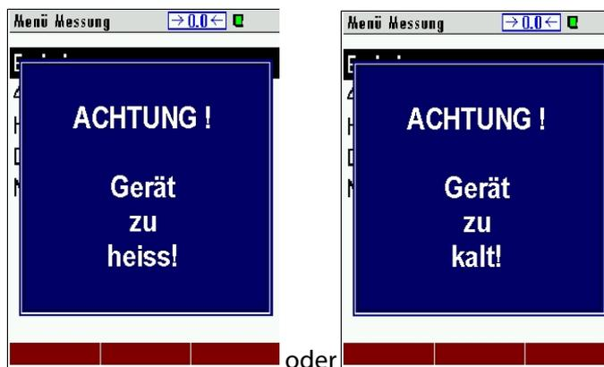
Mit dem OPTIMA 7 BIOGAS ist bei diesen Zuständen keine weitere Funktion möglich – es ertönt während der Aufwärmung ein akustisches Signal.
