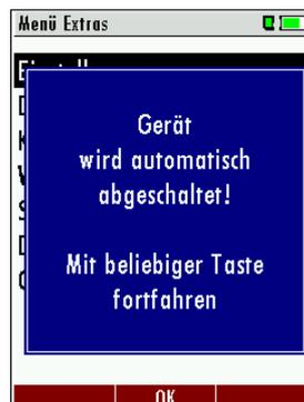
Während einer Messung oder des Akkuladeporgangs mittels Ladegerät/USB-Anschluß ist die Auto-off Funktion deaktiviert.
