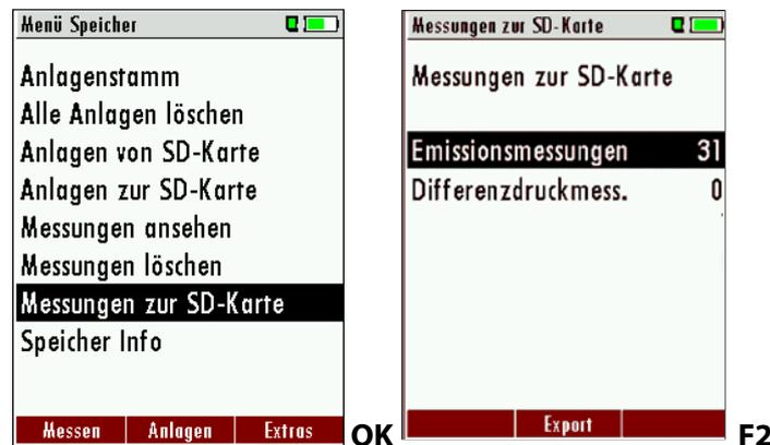
Durch bestätigen mit der **F2** –Taste wird die Datenübertragung/Export auf die SD-Karte gestartet. Während der Übertragung wird in der Anzeige „bitte warten“ angezeigt, bei einer fehlenden oder z.B. schreibgeschützten oder defekten SD-Karte die Hinweismeldung „Fehler! Das Schreiben auf Speicherkarte ist nicht möglich“.
