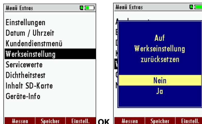
Das Gerät wird auf den Auslieferungsstandard zurückgesetzt:
