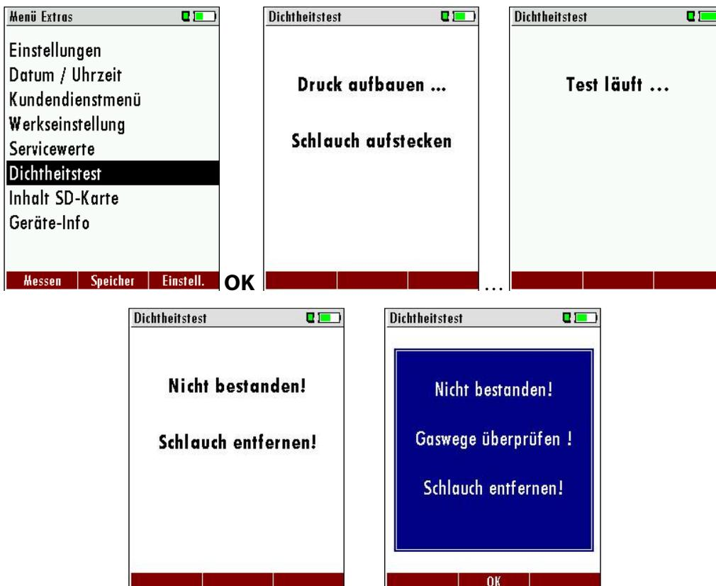
Falls der Dichtheitsprüfung nicht bestanden wird muss das Gerät überprüft werden.
