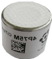
Das Gerät besitzt einen internen LEL-Sensor (Pellistor), der die CH<sub>4</sub>-Konzentration im Innenraum überwacht. Der Pellistor soll den Betreiber warnen, wenn die CH<sub>4</sub>-Konzentration einen kritischen Wert überschreitet und das Gerät in einen betriebssicheren Zustand bringen.
