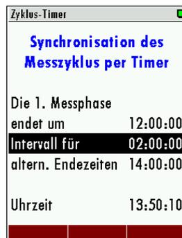
Abb. 2: Im abgebildeten Beispiel wird die Messphase stets um 12 Uhr, 14 Uhr, 16 Uhr, 18 Uhr, 20 Uhr, 22 Uhr, 0 Uhr, 2 Uhr, 4 Uhr, 6 Uhr, 8 Uhr oder 10 Uhr beendet. Das bedeutet, dass die Nullpunktnahmen (außer die erste nach Power-On) stets um diese Zeiten gestartet wird.
