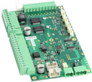
Sie finden den Alarm-Relay Anschluss und den RS-485 Anschluss am Mainboard.
