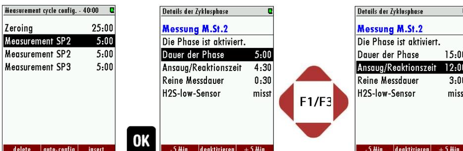
5. Das Detailmenü verlassen und zur nächsten Phase im Konfigurationsmenü gehen. Mit der **links/rechts** Taste die Phase „Nullpunktnahme“ auswählen und die Phasendetails öffnen. Hier die Dauer der Phase auf 15:00 min. stellen und das Detailmenü verlassen.
