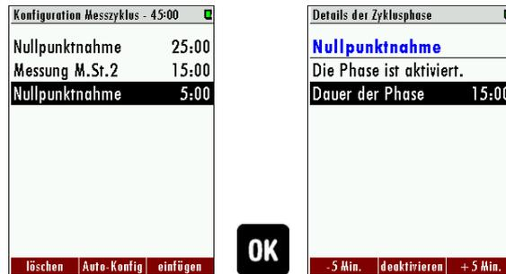
6. Im Konfigurationsmenü den Punkt „Messstelle 1“ erstellen. In das Detailmenü gehen und die Dauer der Phase auf 10 min., den Punkt „Pure Messzeit“ auf 5 min. stellen.
