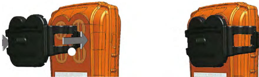
Abbildung 5: Montieren der Kalibrier-/Bump-Test-Platte
