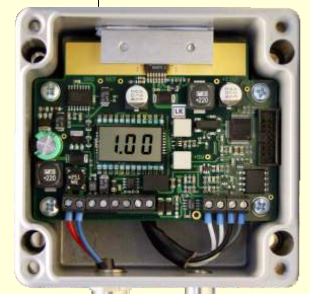
Transmitter TOM 420R Elektronik, LCD-Anzeige und Bedientasten
